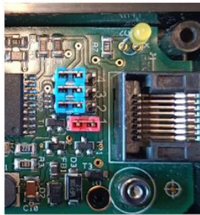
TTL mode (USB-IO box or Nortio TTL Hub)
